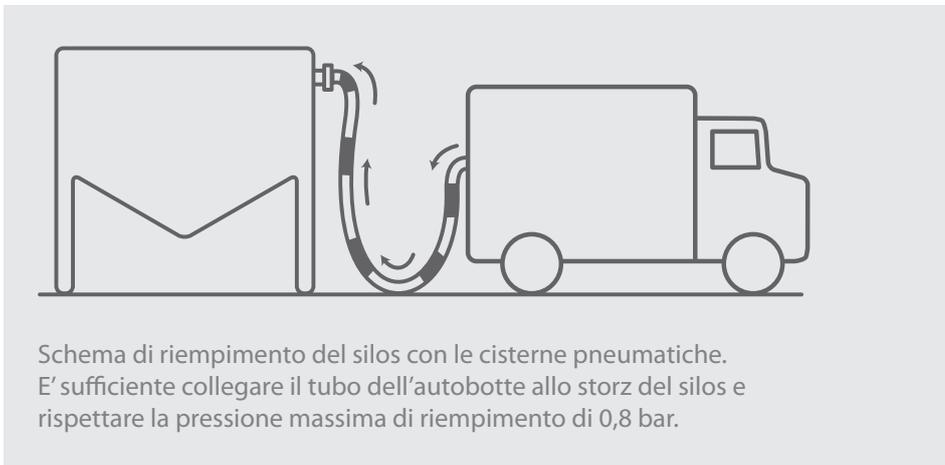
I silos possono essere caricati in modo automatico attraverso le cisterne, che con un sistema pneumatico carica il pellet tramite un tubo di gomma collegato al raccordo Storz del silos, tutti i ns silos sono forniti di raccordo storz. Per il carico automatico. Grazie alle proprietà del tessuto del silos, durante il carico la polvere viene filtrata dal tessuto e non dispersa nell'ambiente.
